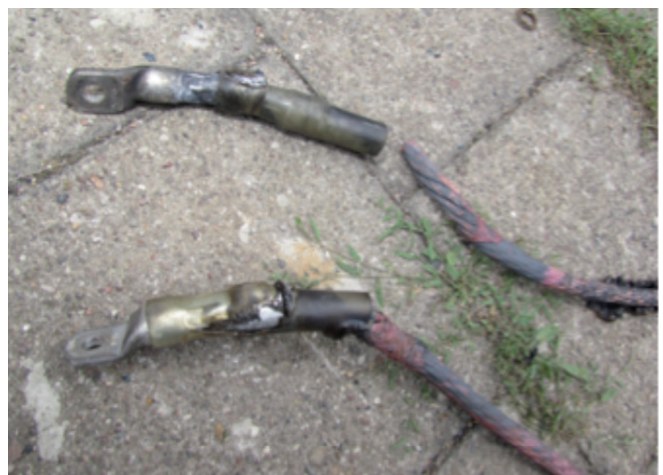
Abb. 9: Verbinderschaden nach Prüfung
