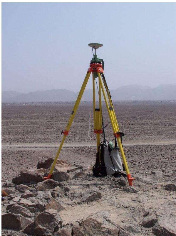
6. Von der GPS-Referenzstation (links) werden die Korrekturdaten an den Rover (rechts) übertragen. / Korekce k měření se přenáší z referenční stanice GPS (vlevo) na rover (vpravo).
