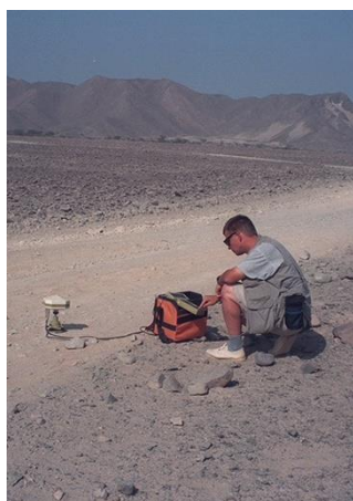
3. Mit Tachymeter (links) werden die ersten neun Figuren in der Pampa von Nasca vermessen. Die Bestimmung von neunzehn Linienzentren und den Tachymeterstandpunkten erfolgt mittels GPS (rechts). / Elektronické tachymetry (vlevo) se používaly k přesnému zaměření prvních devíti geoglyfů v pampě Naska. Určení devíti liniových center i pozic elektronických tachymetrů v poušti se provádělo pomocí GPS (vpravo).
