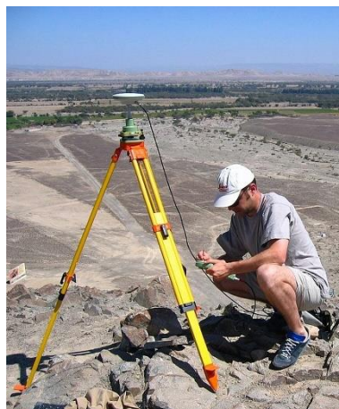
5. Mittels DGPS (Differential Global Positioning System) wurden allein im Jahr 2004 rund 2000 Punkte vermessen. Dabei diente jeweils ein Punkt des Festpunktfeldes als Referenzstation (Abb. rechts), während vier bis fünf Messtrupps mit Rover (Abb. links) die Punkte im Gelände aufnahmen. Über Funk empfingen die Rover Korrekturdaten von der Referenzstation. / Pomocí DGPS (Differential Global Positioning System) se v roce 2004 zaměřilo přibližně 2000 bodů. Jeden bod základního pole sloužil vždy jako referenční staniční bod (obrázek vpravo), zatímco čtyři až pět měřických skupin s přístroji typu rover (obrázek vlevo) měřily body v terénu. Přes radiomodem dostává přístroj typu rover korekční údaje z referenční stanice pro zpřesnění měření.
