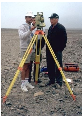
3. Mit Tachymeter (links) werden die ersten neun Figuren in der Pampa von Nasca vermessen. Die Bestimmung von neunzehn Linienzentren und den Tachymeterstandpunkten erfolgt mittels GPS (rechts). / Elektronické tachymetry (vlevo) se používaly k přesnému zaměření prvních devíti geoglyfů v pampě Naska. Určení devíti liniových center i pozic elektronických tachymetrů v poušti se provádělo pomocí GPS (vpravo).
