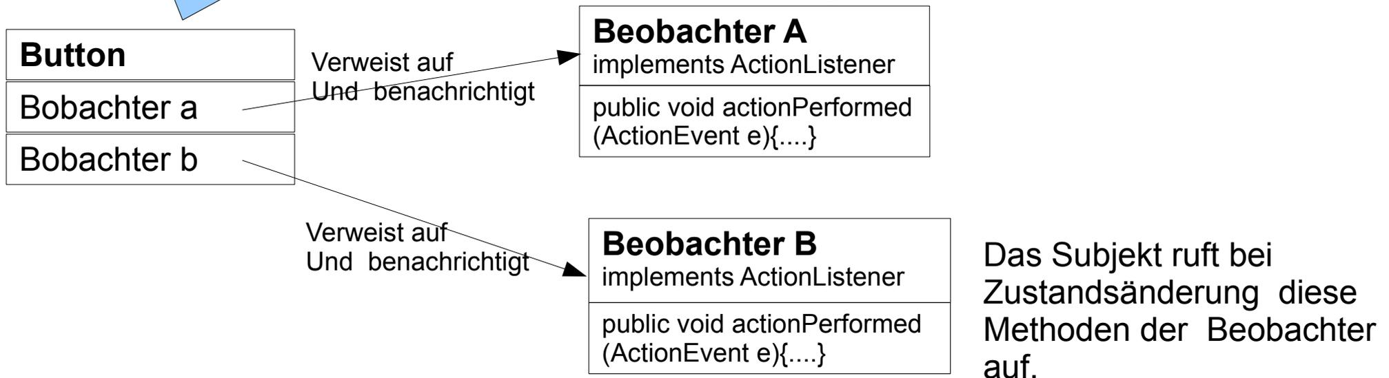
Ein Button ist ein solches Subjekt. Er kann mehrere ActionListener (Beobachter) verwalten, die er beim Betätigen des Buttons benachrichtigt. Die Benachrichtigung erfolgt durch Aufruf der Methode actionPerformed, die im Interface ActionListener deklariert ist und in den Klassen der Listenerobjekte implementiert sein muss.
