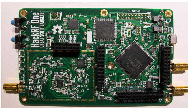
Abbildung 3: HackRF One Platine <sup>3</sup>
