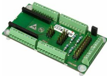
(a) deRFBreakout Board als Border-Router
