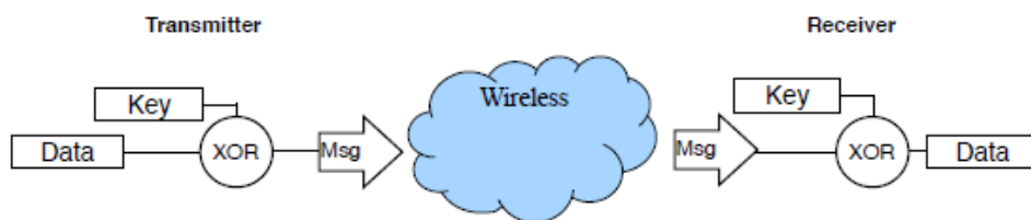
Abbildung 4.3.1.: Ver- und Entschlüsselung mit einfacher XOR-Operation [Prodromos, S. 26]
