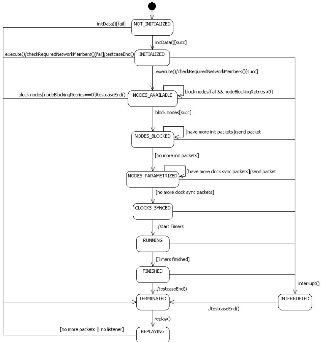
Abbildung 13.7: Mögliche Zustände und Zustandsübergänge eines ausführbaren Testfalles.
