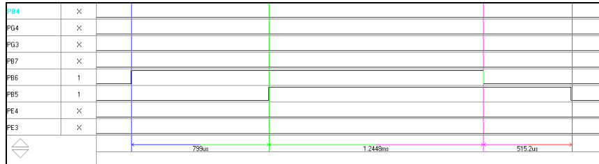
Abbildung 7: Signale Impulsgeber Drehrichtung abwärts
